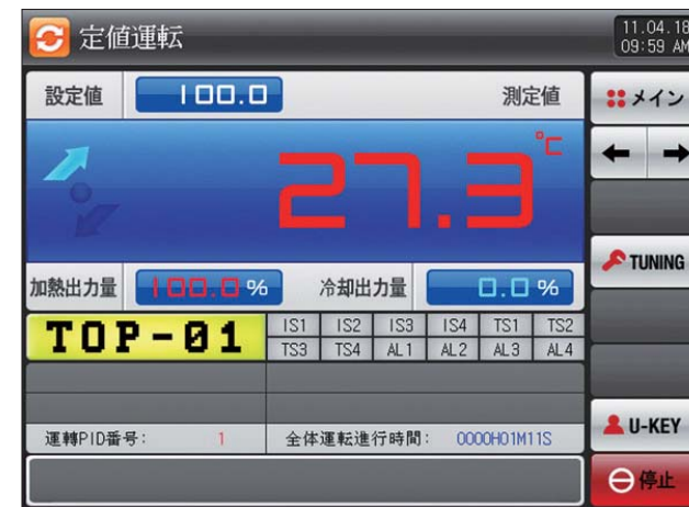
[図4-35] 定値運転の第1運転画面(加熱・冷却)
