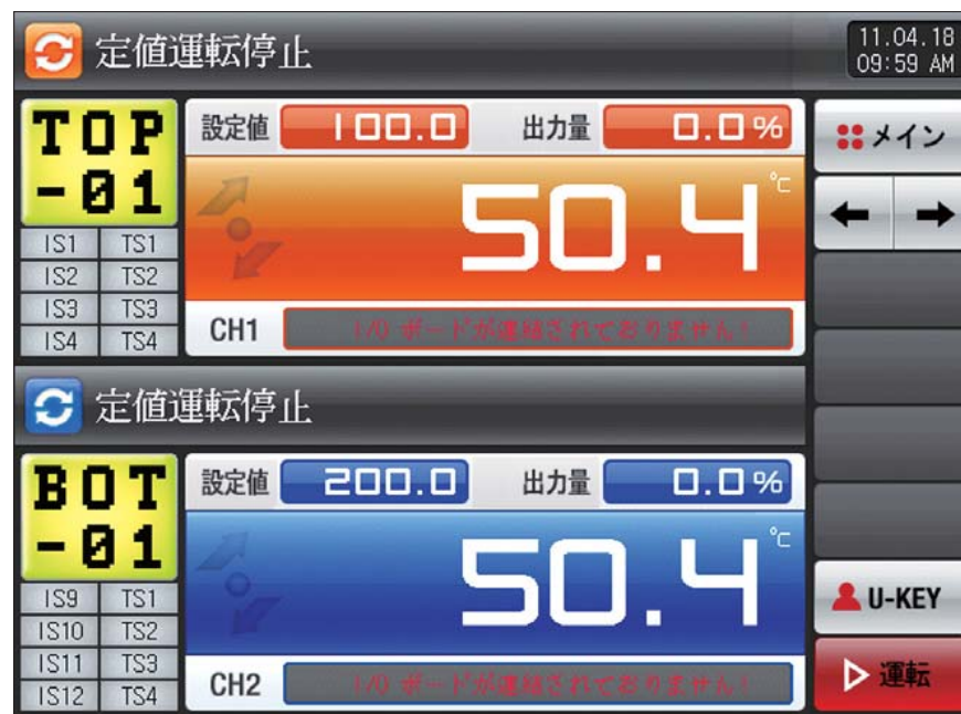
[図10-2] I/Oボードの通信エラー画面
