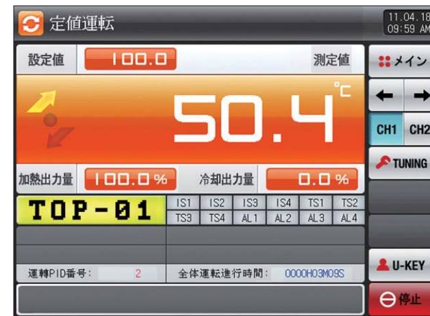
[図4-8]定値運転の第2運転画面(加熱・冷却)
