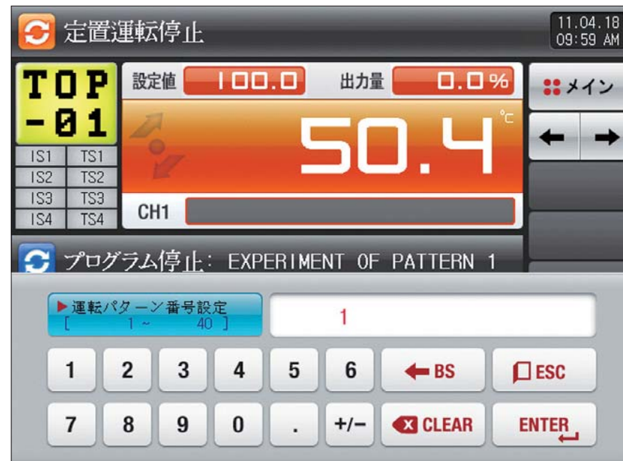
[図4-27] 定値/プログラム運転の停止画面でプログラム運転するパターン番号を設定する入力キーの画面(同期運転)
