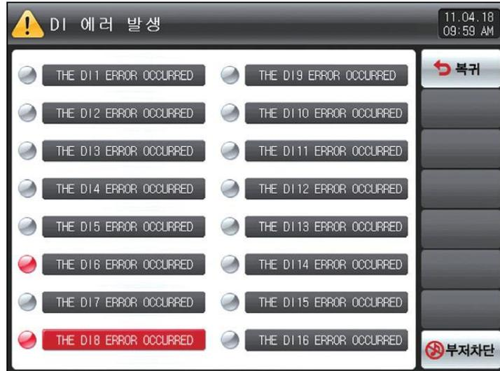
[그림 7-3] DI 에러 표시 방식이 글씨인 화면
