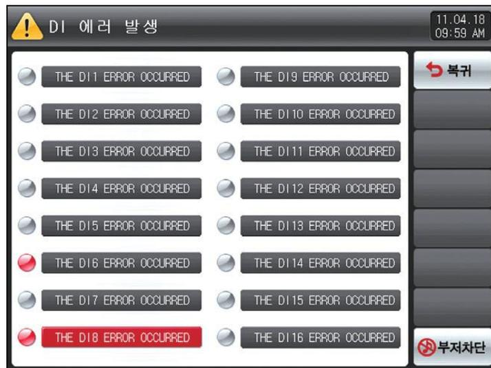
[그림 19-12] DI 에러 표시 방식이 글자인 화면
