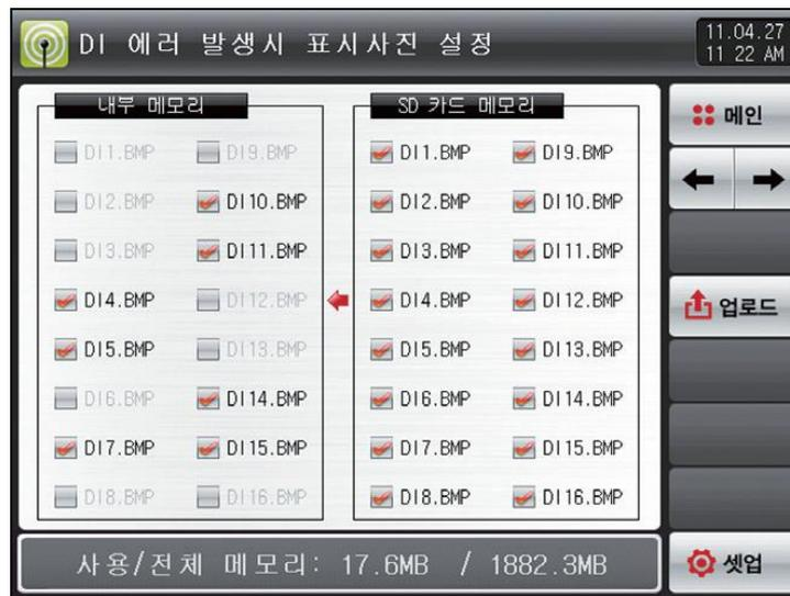
[그림 19-11] DI 에러 발생시 표시사진 설정 화면-4
