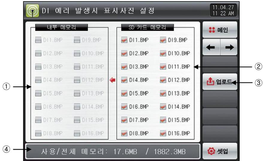
[그림 19-8] DI 에러 발생시 표시사진 설정 화면-1
