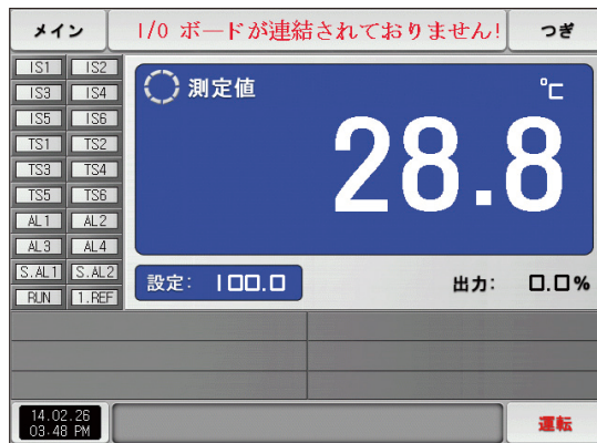
[図9-2] I/Oボードの通信エラー画面
