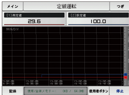
【図3-13】 定値運転の第2運転画面(使用者ボタン)
