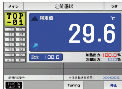
【図3-6】定値運転の第1運転画面(加熱・冷却)
