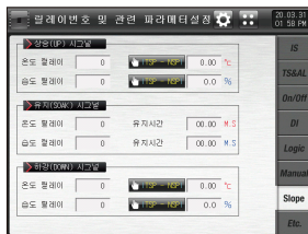
[그림 11-8] 상승시그널/유지시그널/하강시그널 릴레이 설정화면
