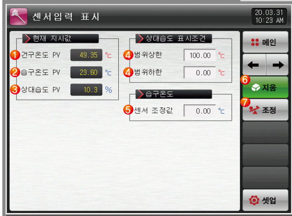
[그림 3-4] 센서입력 표시 화면
