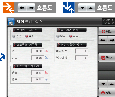
[그림 9-5] PID 그룹 설정화면(가열 · 냉각)
