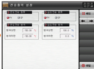
[그림 4-9] 전송출력 선택화면(PV, SP 선택의 경우)
