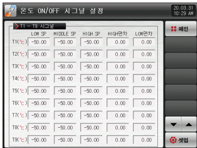
[그림 6-1] 온도 ON/OFF시그널 설정화면
