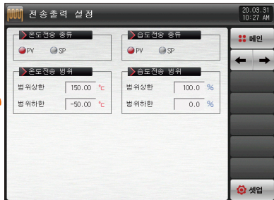
[그림 4-9] 전송출력 선택화면(PV, SP 선택의 경우)
