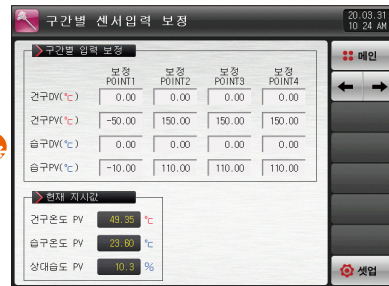
[그림 3-5] 구간별 센서 입력 보정 화면
