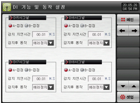
[그림 12-4] DI 기능 및 동작 설정 제 2 화면 #3
