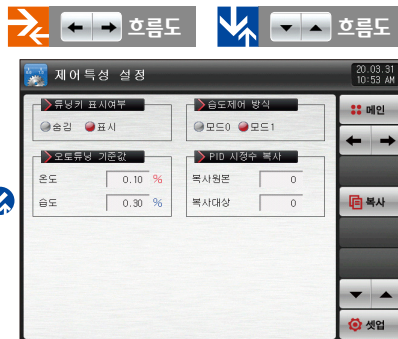
[그림 9-3] PID 그룹 설정화면(일반)
