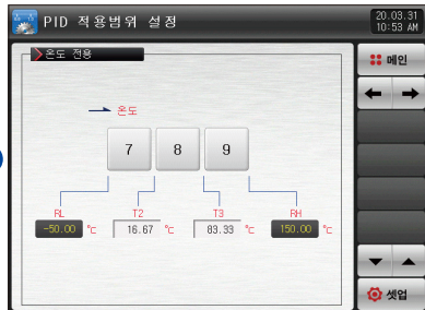
[그림 9-2] PID 적용범위 설정 제 2 화면
