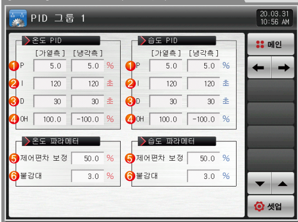
[그림 9-6] PID 그룹 설정화면(가열 · 냉각)
