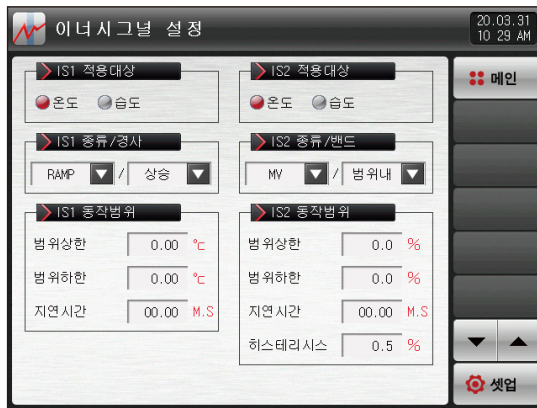
[그림 5-3] 이너시그널 RAMP·MV 일반 제어 설정일 경우 화면
