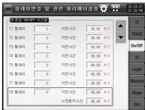
[그림 11-3] 온도 ON/OFF 시그널 릴레이 설정화면
