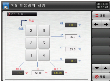
[그림 9-1] PID 적용범위 설정 제 1 화면
