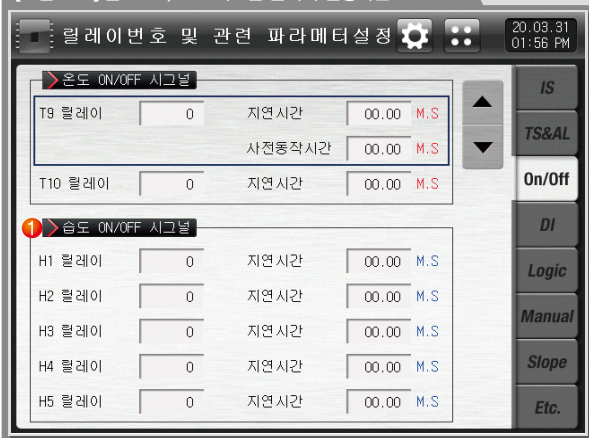
[그림 11-4] 습도 ON/OFF 시그널 릴레이 설정화면
