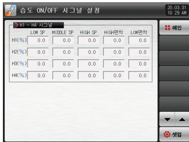
[그림 6-2] 습도 ON/OFF시그널 설정화면
