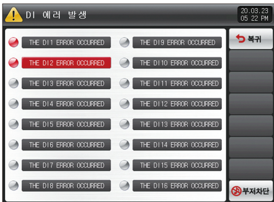
[그림 12-11] DI 에러 표시 방식이 글씨인 화면
