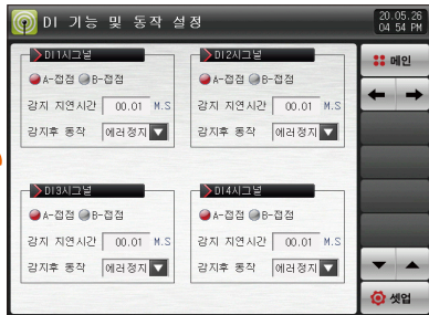
[그림 12-2] DI 기능 및 동작 설정 제 2 화면 #1
