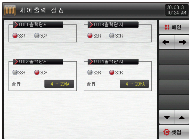
[그림 4-5] OUT 출력종류 선택화면(가열 · 냉각)
