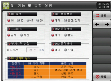
[그림 12-1] DI 기능 및 동작 설정 제 1 화면
