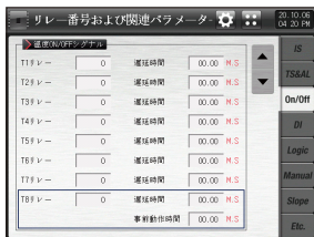
図11-3 温度ON/OFF シグナルのリレー設定画面
