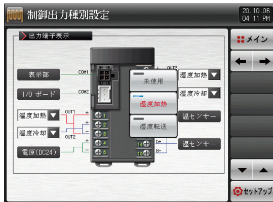
[図 4-7] OUT3出力端子の選択画面(加熱・冷却)
