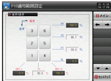
[図9-1] PID適用範囲設定の第1画面
