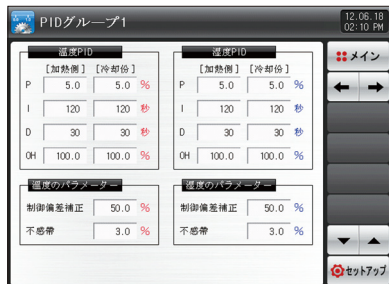
[図9-6] PIDグループの設定画面(加熱・冷却)
