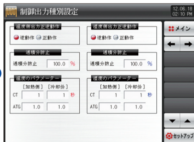
[図4-8] 出力設定画面(加熱・冷却)
