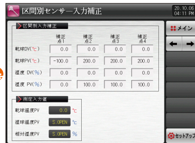
[図3-5] 区間別のセンサー入力補正画面
