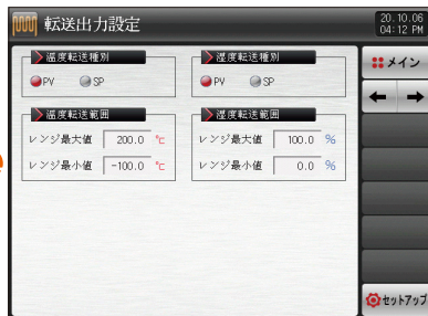
[図4-9] 伝送出力の設定画面(PV、SPを設定する場合)
