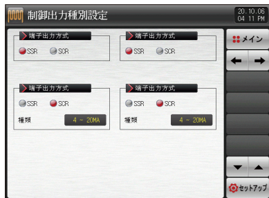
[図4-5] OUT出力の種類選択画面(加熱・冷却)
