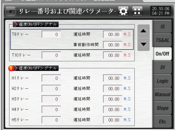
[図T1-4] 湿度ON/OFFシグナルのリレー設定画面
