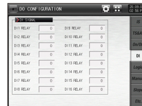
[Fig.11-5] DI signal relay setting screen
