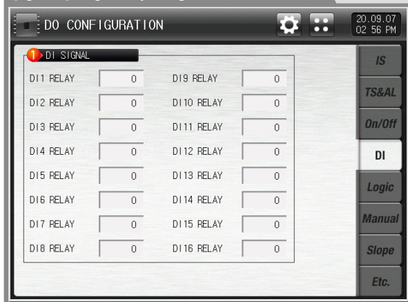
[Fig. 11-5] DI signal relay setting screen
