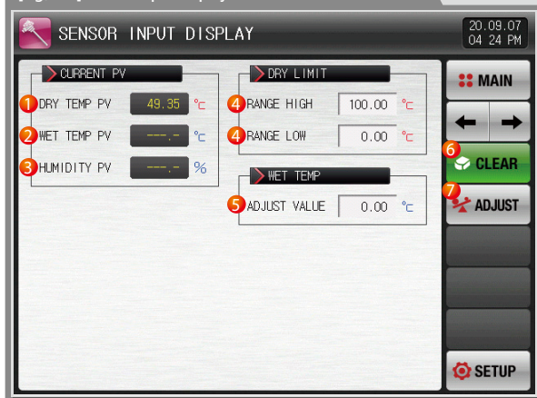
[Fig. 3-4] Sensor input display screen
