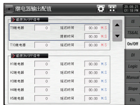
图11-4)湿度ON/OFF信号 继电器设定画面
