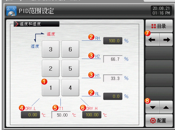
[图9-1]PID适用范围设定第1画面
