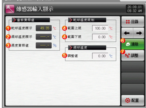
[图3-4]感应输入表示画面
