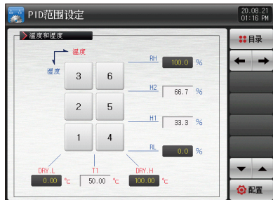
[图8-1]PID适用范围设定第1画面
