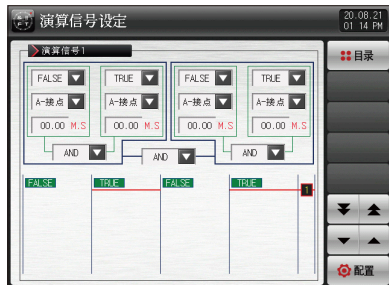
[图7-1]温度ON/OFF信号设定画面
