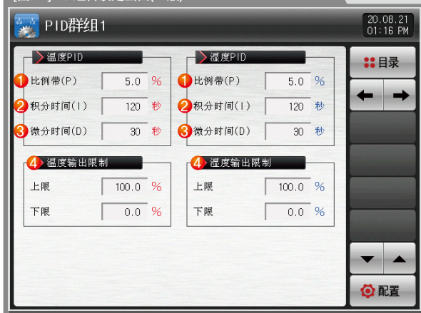
[图9-4] PID组合设定画面(一般)
