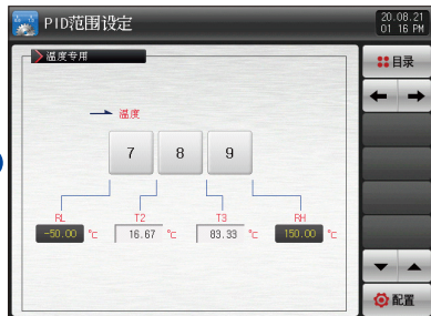
[图8-2]PID适用范围设定第2画面
