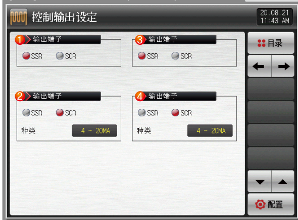
[图4-5]OUT输出端子选择画面(加热・冷却)
