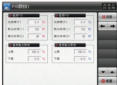
[图8-4]PID组合设定画面(一般)
