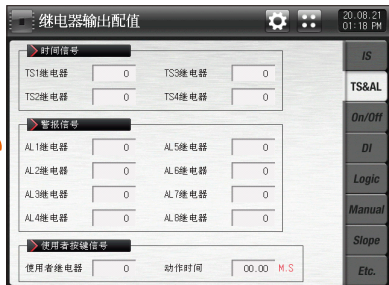
[图11-2]时间信号/警报信号/使用者按键信号继电器设定画面
