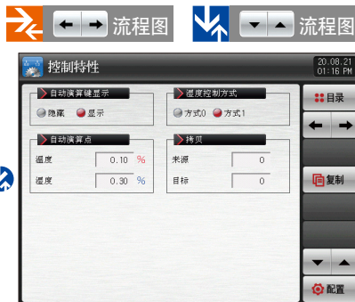
[图8-3]PID组合设定画面(一般)
