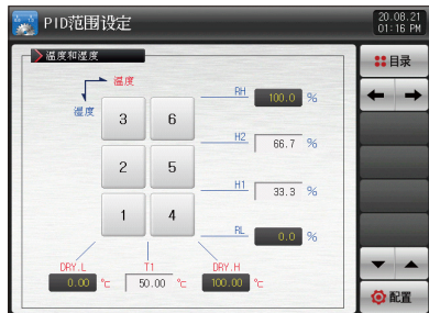
[图8-1]PID适用范围设定第1画面
