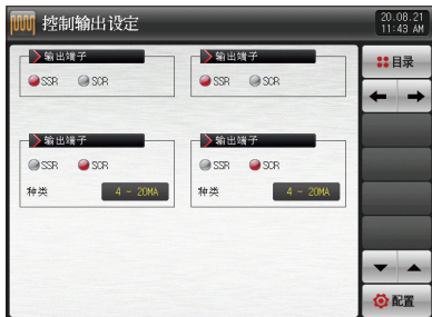
[图4-5]OUT输出种类选择画面(加热・冷却)
