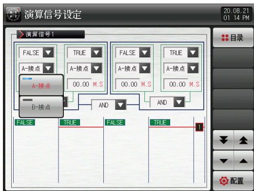
[图 7-3] 演算信号感知方式设定画面
