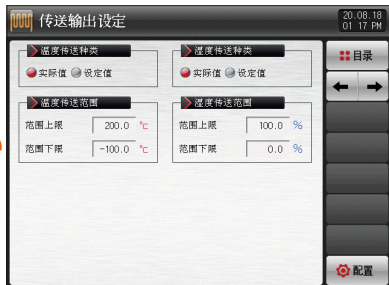
[图4-9]传送输出设定画面(设定PV・SP的时候)
