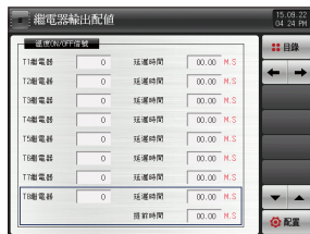
图11-3)温度ON/OFF信号 继电器设定画面
