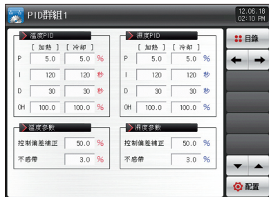
[图8-6]PID组合设定画面(加热・冷却)
