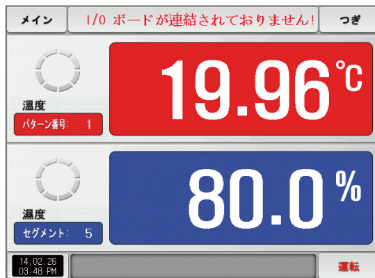
[図9-2] I/Oボードの通信エラー画面
