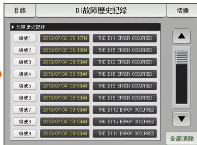
[图8-8] DI故障历史记录画面
